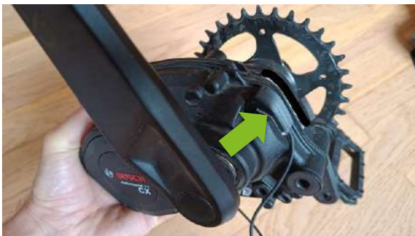
[Foto č.1a CX – správná poloha simulátoru]
