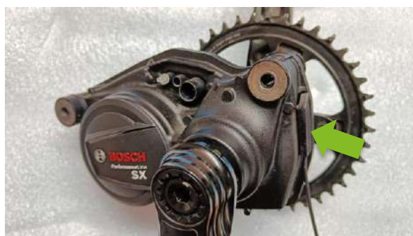
[Foto č.1c SX – horní uchycení šroubů motoru – správná poloha simulátoru]
