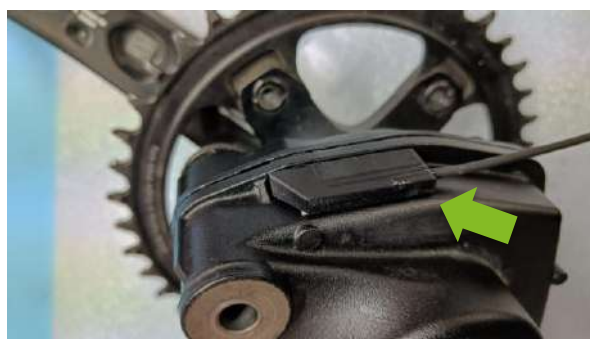
[Foto č.1c SX – horní uchycení šroubů motoru – správná poloha simulátoru]
