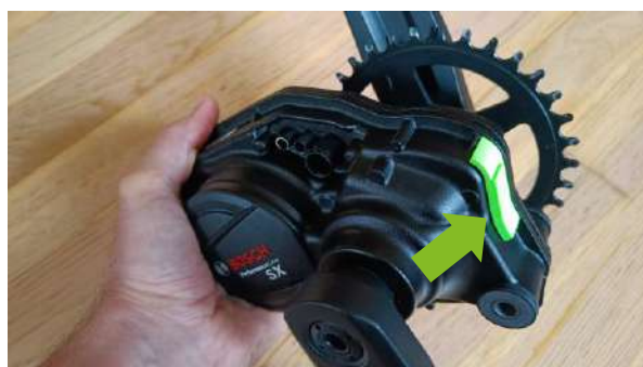
[Foto č.1b SX – diagonální uchycení šroubů motoru – správná poloha simulátoru]
